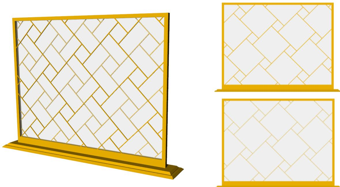
支柱もしくは台座部分に LED 光源を配し、アクリルパネル部分に当社製品 [SA ライトガイド](https://www.sumika-acryl.co.jp/products/salite/detail01.html)（<https://www.sumika-acryl.co.jp/products/salite/detail01.html>）を使用して、表裏で組子の配置を変えれば、発光時の模様・ロゴ表示や隣席とのプライバシー保護だけでなく、消灯時と点灯時で違った様相を見せることも可能です。
